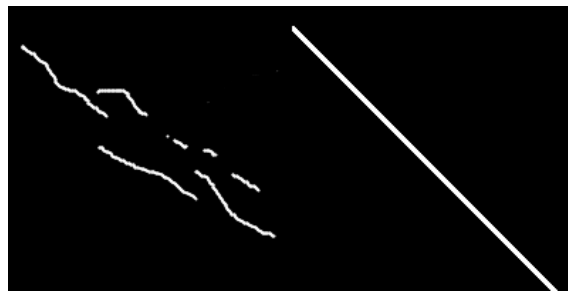
Рис. 4. Аппроксимация набора светлых точек прямолинейным отрезком
