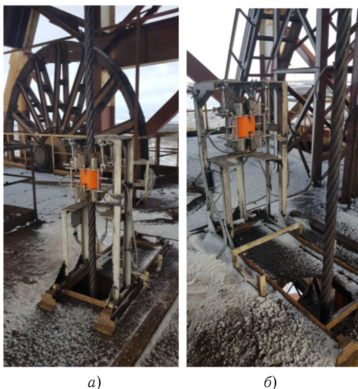
Рис. 1. Установка магнитного дефектоскопа стального каната
