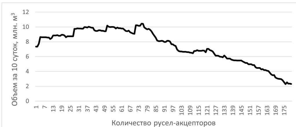
Рис. 4. Зависимость оценки дополнительного объема воды, попадающего в русла-акцепторы ВАП, от количества акцепторов
